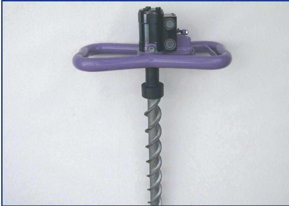
Die hydraulische Bohrmaschine für den Bergbau HWG/SM ist vorgesehen zum manuellen Bohren von Löchern in Kohle und Felsen von mittlerer Härte. Sie ist ausgelegt zum Bohren von Löchern mit einem Durchmesser von  $\Phi$  42 mm und einer Tiefe von 6 m bei Version HWG/SM m = 0,5, 12 m bei Version m = 0,6, 20 m bei Version m = 0,75 mit Hilfe von typischen, im Bergbau benutzten Spiralbohrer.
